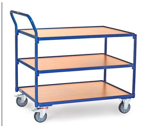
Ensemble mécano-soudé, revêtement époxy bleu RAL 5007 avec 3 plateaux en mélaminé surface effet hêtre, barre de poussée verticale, rebord de 12 mm. Charge maximum étagère haute et médiane: 80 kg. 2 roues pivotantes et 2 roues fixes à bandage TPE, moyeu à roulement à billes central. Freins sur roues pivotantes.
