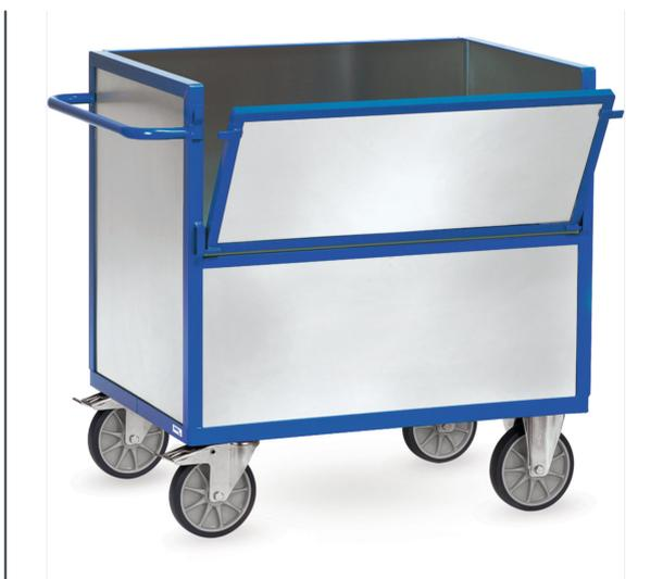
Ensemble mécano-soudé revêtement époxy RAL 5007. Chariot entièrement en tôle d'acier zinguée collée dans les profilés. 2 roues pivotantes et 2 roues fixes à bandage TPE, moyeu à roulement à billes central. Freins sur roues pivotantes.
