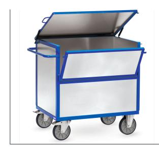
Ensemble mécano-soudé, revêtement époxy bleu RAL 5007. Chariot entièrement en tôle d'acier zinguée collée dans les profilés. Couvercle à un battant et anneau pour cadenas. 2 roues pivotantes et 2 roues fixes à bandage TPE, moyeu à roulement à billes central. Freins sur roues pivotantes.
