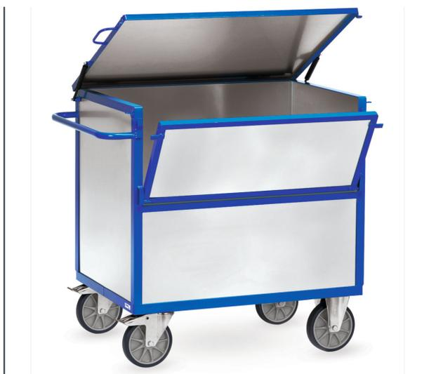
Ensemble mécano-soudé, revêtement époxy bleu RAL 5007. Chariot entièrement en tôle d'acier zinguée collée dans les profilés. Couvercle à un battant et anneau pour cadenas. 2 roues pivotantes et 2 roues fixes à bandage TPE, moyeu à roulement à billes central. Freins sur roues pivotantes.
