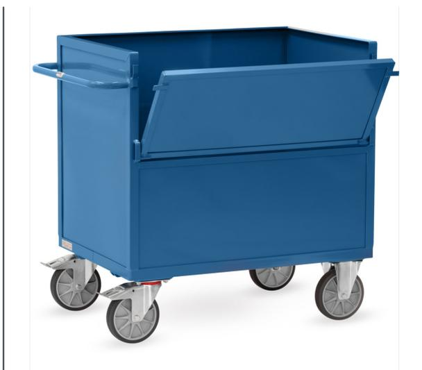
Ensemble mécano-soudé, revêtement époxy bleu RAL 5007. Chariot entièrement en tôle d'acier. 2 roues pivotantes et 2 roues fixes à bandage TPE, moyeu à roulement à billes central. Freins sur roues pivotantes.
