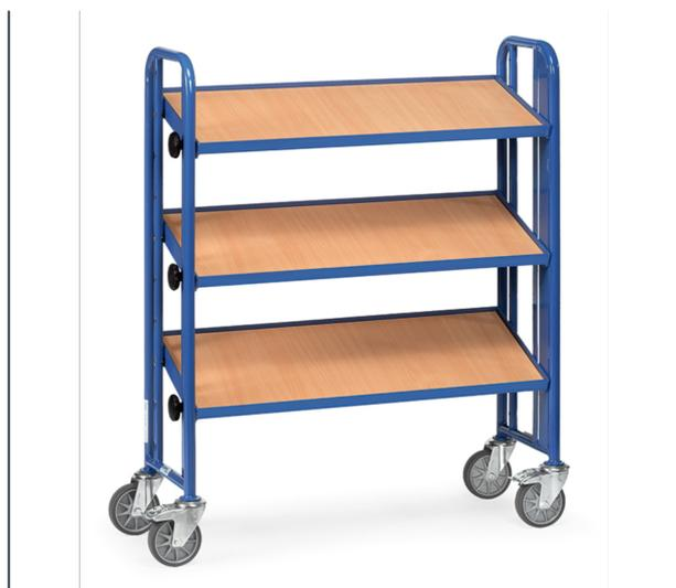
Ensemble mécano-soudé, revêtement époxy bleu RAL 5007. 3 plateaux en mélaminé surface effet hêtre avec rebord de 12 mm. Dim utiles 900 x 315 mm. Plateaux réglables au pas de 100 mm et inclinables de 0° à 35°. Fixation au moyen d'une molette assurant un serrage sécurisé. 4 roues pivotantes à bandage TPE, moyeu à roulement à rouleaux. 2 roues avec freins. Charge par plateau: 60 kg. Livré sans bacs.
