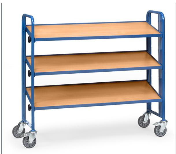
Ensemble mécano-soudé, revêtement époxy bleu RAL 5007. 3 plateaux en mélaminé surface effet hêtre avec rebord de 12 mm. Dim utiles 1240 x 415 mm. Plateaux réglables au pas de 100 mm et inclinables de 0° à 35°. Fixation au moyen d'une molette assurant un serrage sécurisé. 4 roues pivotantes à bandage TPE, moyeu à roulement à rouleaux. 2 roues avec freins. Charge par plateau 60 kg.
