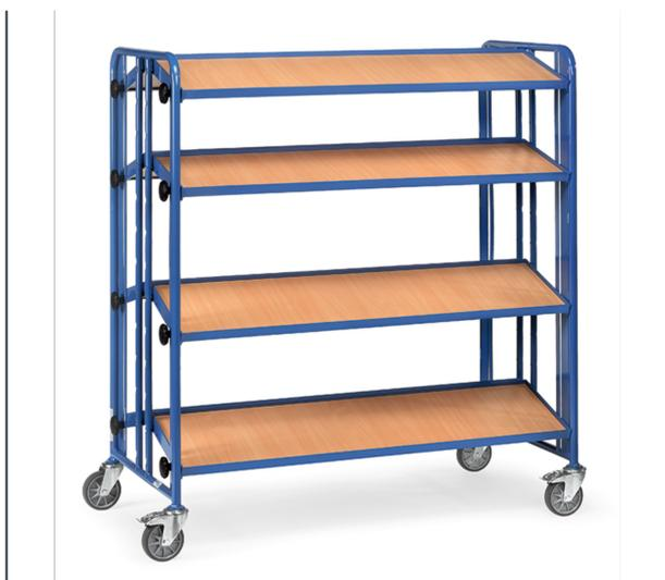
Ensemble mécano-soudé, revêtement époxy bleu RAL 5007. Chariot 2 faces avec 2x 4 plateaux en mélaminé surface effet hêtre et rebord de 12 mm. Dim utiles 1280 x 2 x 315 mm. Plateaux réglables au pas de 100 mm et inclinables de 0° à 35°. Fixation au moyen d'une molette assurant un serrage sécurisé. 4 roues pivotantes à bandage TPE, moyeu à roulement à rouleaux. 2 roues avec freins. Charge par plateau: 60 kg. Livré sans bacs.
