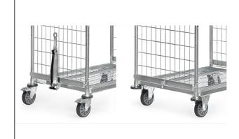
En convoi de 3 chariots maxi. A la place des 2 roues pivotantes sans freins sont montées des roues fixes. Timon en fer plat profilé. Avec ressort de rappel à gaz. Attache en tube profilé du côté opposé. Couplage par pression du pied. Vitesse maximale 6 km/h.Non livrable avec marchepied.
