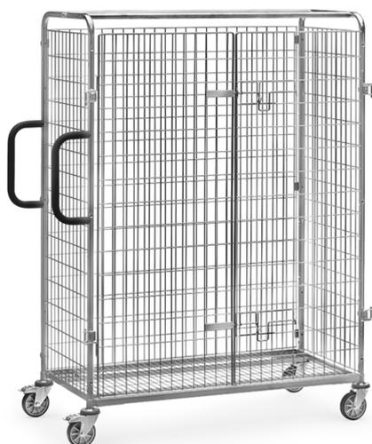
Double-portes battantes. Treillis galvanisé, maille de 100 x 50 mm, charnières à boulonner, la porte peut se rabattre à 180° vers le corps du chariot, 2 loquets en fil zingué verrouillables par cadenas (Cadenas non fourni).
