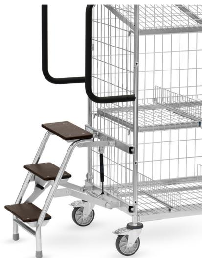
3 Marches, la plus haute à 600 mm, Hauteur de prise 2.800 mm. Poignée en acier, marche en bois antidérapant. Peut être déplacé en position basse sinon il reste bloqué par le poids de l'utilisateur. Une butée empêche le chariot de basculer. Le marchepied peut être facilement escamoté grâce à un vérin à gaz. En même temps que le marchepied sont livrés des poignées adaptées, plus grandes. La longueur totale est rallongée de 100 mm. Non livrable avec timon et attache.
