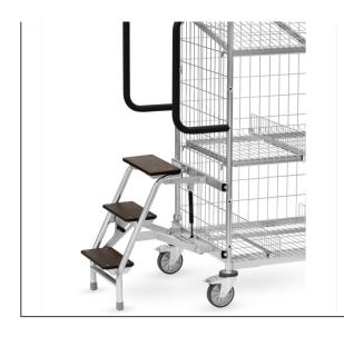
3 Marches, la plus haute à 600 mm, Hauteur de prise 2.800 mm. Poignée en acier, marche en bois antidérapant. Peut être déplacé en position basse sinon il reste bloqué par le poids de l'utilisateur. Une butée empêche le chariot de basculer. Le marchepied peut être facilement escamoté grâce à un vérin à gaz. En même temps que le marchepied sont livrés des poignées adaptées, plus grandes. La longueur totale est rallongée de 100 mm. Non livrable avec timon et attache.
