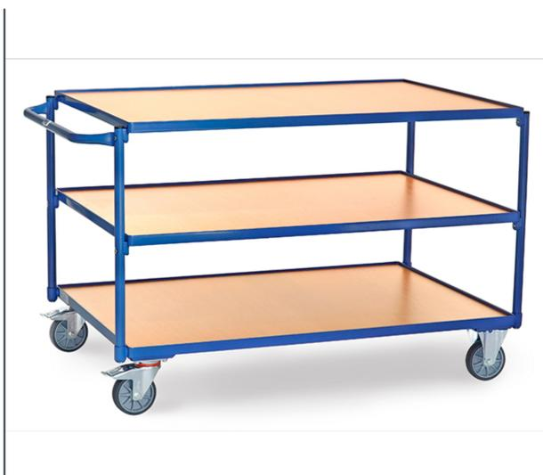
Ensemble mécano-soudé, revêtement époxy bleu RAL 5007 avec 3 plateaux en mélaminé surface effet hêtre, barre de poussée horizontale, rebord de 12 mm. Charge maximum de l'étagère haute et médiane: 80 kg. 2 roues pivotantes et 2 roues fixes à bandage TPE, moyeu à roulement à billes central. Freins sur roues pivotantes.
