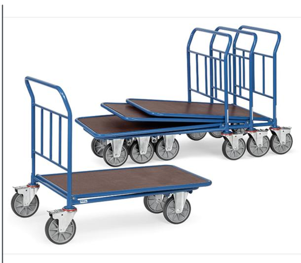
Ensemble mécano-soudé, revêtement époxy bleu RAL 5007. Plateau antidérapant plastifié et hydrofuge. Largeur 643 mm. 2 roues pivotantes et 2 roues fixes à bandage TPE, moyeu à roulement à billes central. Freins sur roues pivotantes.
