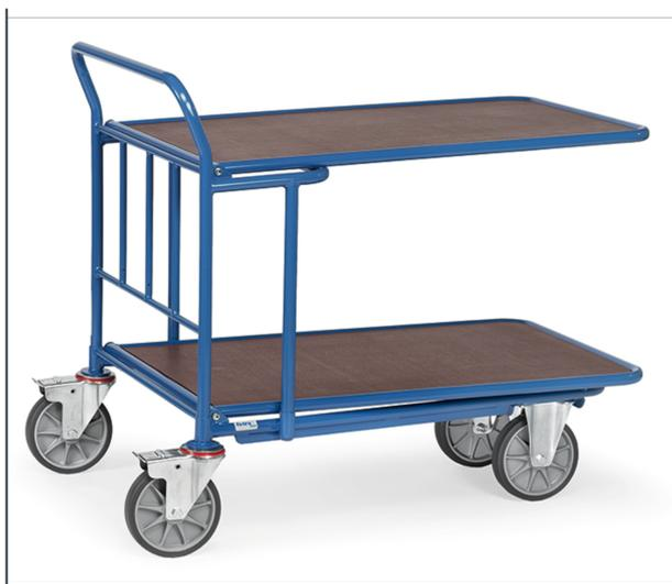
Ensemble mécano-soudé, revêtement époxy bleu RAL 5007. 2 plateaux antidérapants plastifiés et hydrofuges. Largeur 643 mm. 2 roues pivotantes et 2 roues fixes à bandage TPE, moyeu à roulement à billes central. Freins sur roues pivotantes. Charge maximum plateau du haut: 80 kg.
