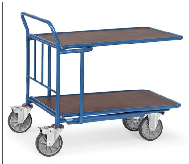
Ensemble mécano-soudé, revêtement époxy bleu RAL 5007. 2 plateaux antidérapants plastifiés et hydrofuges. Largeur 743 mm. 2 roues pivotantes et 2 roues fixes à bandage TPE, moyeu à roulement à billes central. Freins sur roues pivotantes. Charge maximum plateau du haut: 80 kg.
