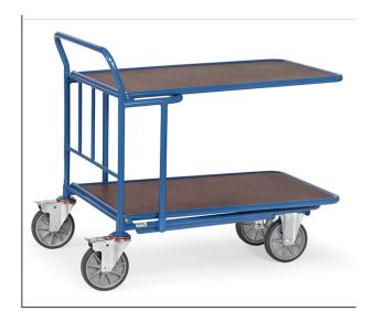
Ensemble mécano-soudé, revêtement époxy bleu RAL 5007. 2 plateaux antidérapants plastifiés et hydrofuges. Largeur 843 mm. 2 roues pivotantes et 2 roues fixes à bandage TPE, moyeu à roulement à billes central. Freins sur roues pivotantes. Charge maximum plateau du haut: 80 kg.
