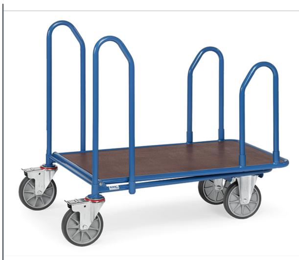
Ensemble mécano-soudé, revêtement époxy bleu RAL 5007. Plateau antidérapant plastifié et hydrofuge. A la place des dossiers, 2 arceaux hauteur 680 mm au niveau des roues pivotantes et 500 mm au niveau des roues fixes. Largeur 643 mm. 2 roues pivotantes et 2 roues fixes à bandage TPE, moyeu à roulement à billes central. Freins sur roues pivotantes.
