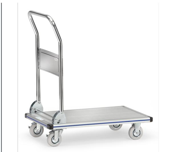
Chariot à plateforme aluminium avec rebord et surface antidérapante et dossier de poussée rabattable. 2 roues pivotantes et 2 roues fixes à bandage caoutchouc, moyeu à roulement palier lisse.
