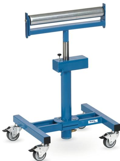
Pour la manutention de pièces longues à tronçonner, percer ou à emboutir. Rotatif avec hauteur réglable par piston pneumatique. Rouleau de manutention en acier de Ø 60 mm, 450 mm de large, sur roulement à billes avec pattes d'arrêt de 20 mm des 2 côtés au-dessus du rouleau (s'escamote automatiquement pour les pièces larges). 4 roues pivotantes à bandage TPE, moyeu à palier lisse. 2 roues avec freins.
