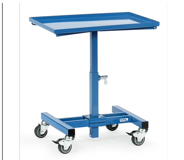
Pour bacs en plastique, bacs en tôle d'acier, corbeilles en fil métallique, etc., réglable en hauteur et mobile. Construction en profilé et tube d'acier avec plateau en tôle avec rebord de 20 mm. Non inclinable. Hauteur réglable au pas de 25 mm. Revêtement époxy bleu RAL 5007. 4 roues pivotantes à bandage TPE, roulement à palier lisse. 2 roues avec freins.
