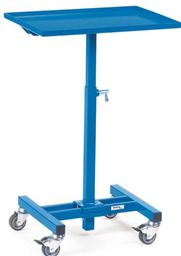
Pour bacs en plastique, bacs en tôle d'acier, corbeilles en fil métallique, etc., réglable en hauteur et mobile. Construction en profilé et tube d'acier avec plateau en tôle avec rebord de 20 mm. Non inclinable. Hauteur réglable au pas de 25 mm. Revêtement époxy bleu RAL 5007. 4 roues pivotantes à bandage TPE, roulement à palier lisse. 2 roues avec freins.
