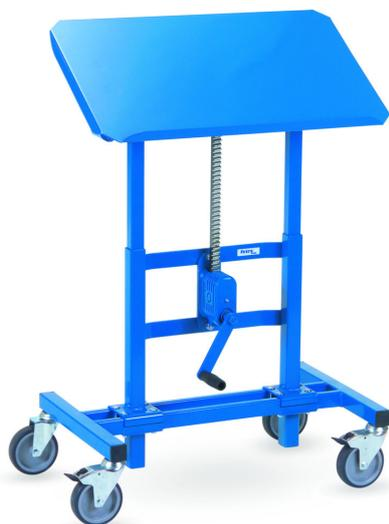
Construction en profilé et tube d'acier avec plateau en tôle d'acier et rebord de 20 mm sur un grand côté, revêtement époxy bleu RAL 5007. Pour bacs en plastiques, corbeilles en treillis etc.. Hauteur réglable (même chargé), par une crémaillère avec 2 guides télescopiques. Inclinaison de 0°, 15° et 30°. 4 roues pivotantes à bandage TPE, moyeu à palier lisse. 2 roues avec freins.
