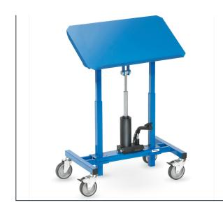
Construction en profilé et tube d'acier avec plateau en tôle d'acier et rebord de 20 mm sur un grand côté, revêtement époxy bleu RAL 5007. Pour bacs en plastiques, corbeilles en treillis etc.. Hauteur réglable (même chargé) par pompe hydraulique, montée par pédale, descente précise par molette. Inclinable de 0°, 15° et 30°. 4 roues pivotantes à bandage TPE, moyeu à palier lisse. 2 roues avec freins.
