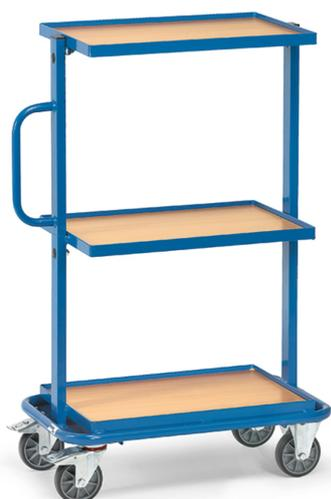
Ensemble mécano-soudé, revêtement époxy bleu RAL 5007. 3 plateaux en mélaminé surface effet hêtre avec rebord de 13 mm. 2 roues fixes et 2 roues pivotantes à bandage TPE, moyeu à roulement à billes. Freins sur roues pivotantes. Charge plateau haut et intermédiaire: 50 kg.
