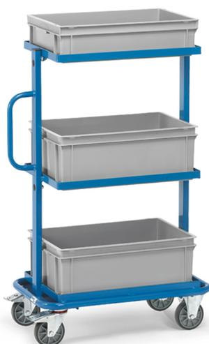
Ensemble mécano-soudé, revêtement époxy bleu RAL 5007. 3 plateaux armature ouverte et 3 bacs plastiques: 1 de 600 x 400 x 145 mm, 2 de 600 x 400 x 220 mm. 2 roues fixes et 2 pivotantes à bandage TPE, moyeu à roulement à billes. Freins sur roues pivotantes. Charge plateau haut et intermédiaire: 50 kg.
