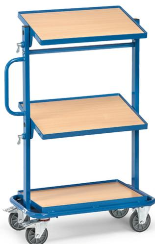
Ensemble mécano-soudé, revêtement époxy bleu RAL 5007. 3 plateaux en mélaminé surface effet hêtre avec rebord de 13 mm. Plateaux inclinables de 15° et 30°. 2 roues fixes et 2 roues pivotantes à bandage TPE, moyeu à roulement à billes. Freins sur roues pivotantes. Charge plateau haut et intermédiaire: 50 kg.
