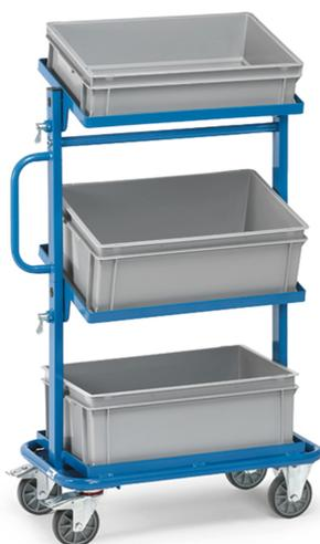
Ensemble mécano-soudé, revêtement époxy bleu RAL 5007. 3 plateaux en profilé avec armature ouverture et 3 bacs plastiques: 1 de 600 x 400 x 145 mm, 2 de 600 x 400 x 220 mm. Plateaux inclinables de 15° et 30°. 2 roues fixes et 2 roues pivotantes à bandage TPE, moyeu à roulement à billes. Freins sur roues pivotantes. Charge plateau du haut et intermédiaire: 50 kg.
