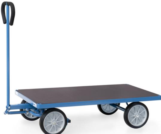
En tube d'acier soudé, revêtement époxy bleu RAL 5007. Plateau en contreplaqué hydrofuge. Essieu avec timon. Roues à bandage caoutchouc, moyeu à roulement à rouleaux. Poignée sécurisée avec revêtement souple remontant automatiquement en position verticale. Blocage automatique de l'essieu avant.
