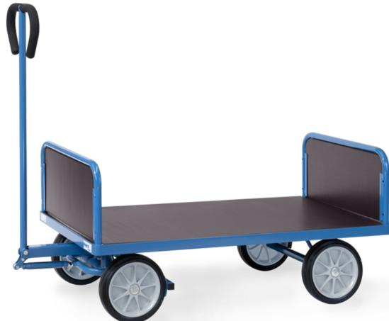
En tube d'acier soudé, revêtement époxy bleu RAL 5007. plateau en contreplaqué hydrofuge, avec 2 ridelles petits côtés hauteur 300 mm, châssis en tube d'acier. Essieu avec timon et poignée. Roues à bandage caoutchouc, moyeu à roulement à rouleaux. Poignée sécurisée avec revêtement souple remontant automatiquement en position verticale. Blocage automatique de l'essieu avant.
