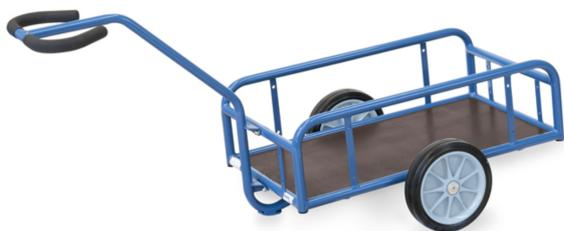
Char à bras léger en tube et profilé d'acier soudés, revêtement époxy bleu RAL 5007. Timon sécurisé boulonné avec revêtement souple. Plateau en contreplaqué hydrofuge. Roues à bandage caoutchouc, moyeu à roulement à rouleaux.
