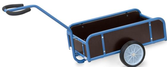
Char à bras léger en tube d'acier soudé, revêtement époxy bleu RAL 5007. Timon sécurisé boulonné avec revêtement souple. Plateau en contreplaqué hydrofuge. Avec 4 ridelles en contreplaqué hydrofuge hauteur 250 mm. Roues à bandage, moyeu à roulement à rouleaux.
