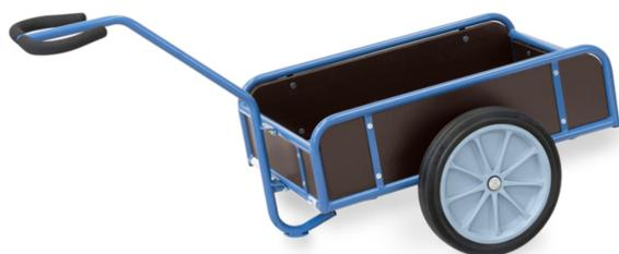
Char à bras léger en tube d'acier soudé, revêtement époxy bleu RAL 5007. Timon sécurisé boulonné avec revêtement souple. Plateau en contreplaqué hydrofuge. Avec 4 ridelles en contreplaqué hydrofuge hauteur 250 mm. Roues à bandage caoutchouc, moyeu à roulement à rouleaux.
