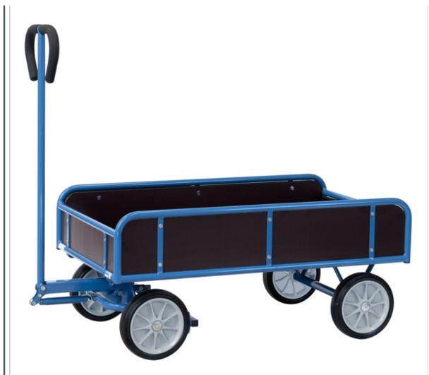
En tube d'acier soudé, revêtement époxy bleu RAL 5007. Ridelles hauteur 250 mm, Plateau et ridelles en contreplaqué hydrofuge. Essieu avec timon. Roues à bandage caoutchouc, moyeu à roulement à rouleaux. Poignée sécurisée avec revêtement souple remontant automatiquement en position verticale. Blocage automatique de l'essieu avant.
