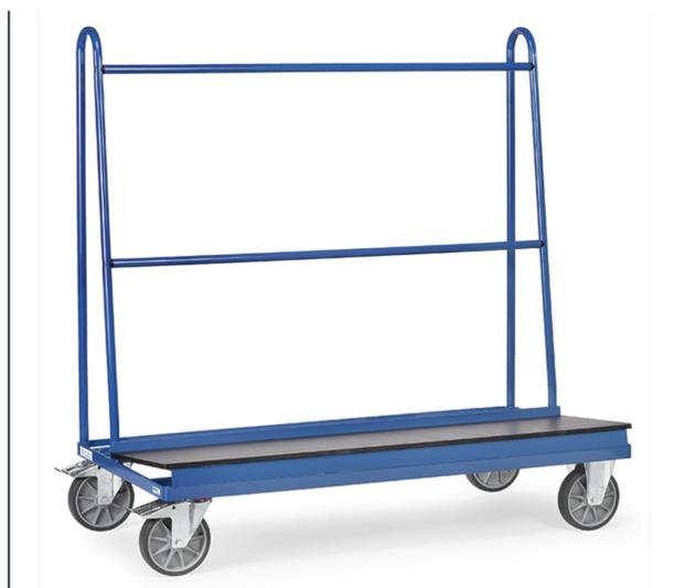
Ensemble mécano-soudé, revêtement époxy bleu RAL 5007, plateau en contreplaqué hydrofuge et antidérapant. 2 roues pivotantes et 2 roues fixes à bandage TPE 200 x 40 mm, moyeu à roulement à billes central. Freins sur roues pivotantes. Hauteur utile 1150 mm.
