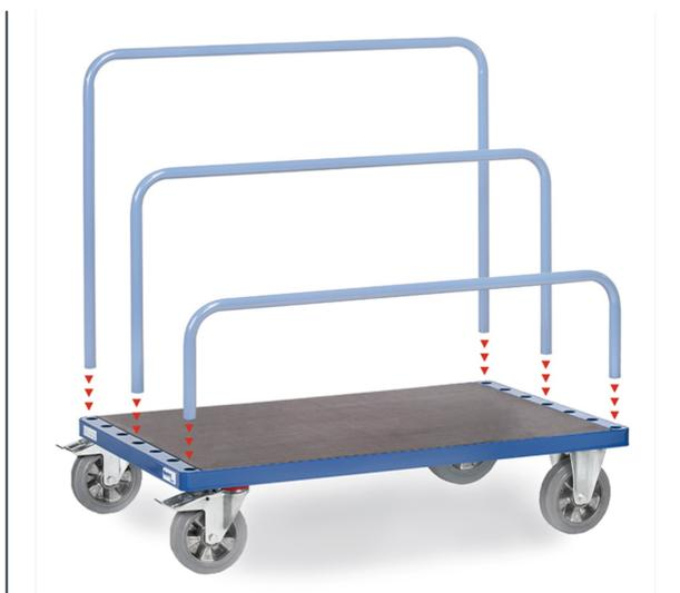
Ensemble mécano-soudé, revêtement époxy, plateforme en bois. 7 positions pour insérer des ridelles tubulaires distantes de 90 mm. 2 roues fixes et 2 roues pivotantes à bandage caoutchouc élastique bleu-gris non traçant, moyeu à roulement à billes. Freins sur roues pivotantes. Livré sans tubes cintrés.
