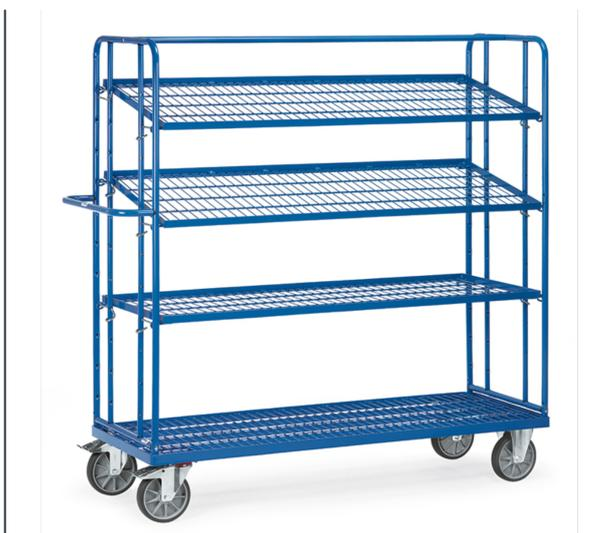
Ensemble mécano-soudé, revêtement époxy bleu RAL 5007. 1 plateau fixe et 3 plateaux amovibles en treillis soudés de 140 x 40 mm. Plateaux amovibles réglables au pas de 120 mm. Angle d'inclinaison 15° ou 30°. 2 roues pivotantes et 2 roues fixes à bandage TPE, moyeu à roulement à billes central. Freins sur roues pivotantes.
