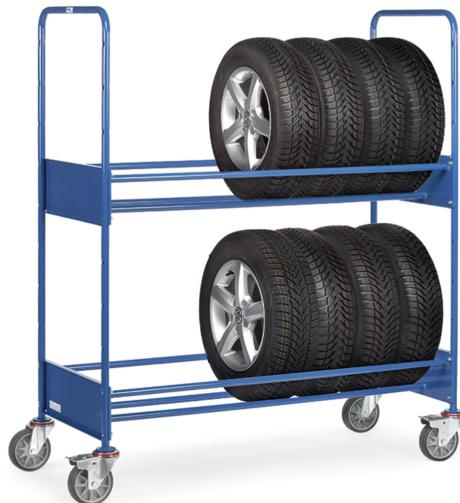
Construction en tube d'acier, revêtement époxy bleu RAL 5007. Supports de pneumatiques réglables au pas de 150 mm avec ridelle en tôle d'acier. 4 roues pivotantes à bandage TPE 160 x 40 mm, moyeu à roulement à billes central. 2 roues avec freins.
