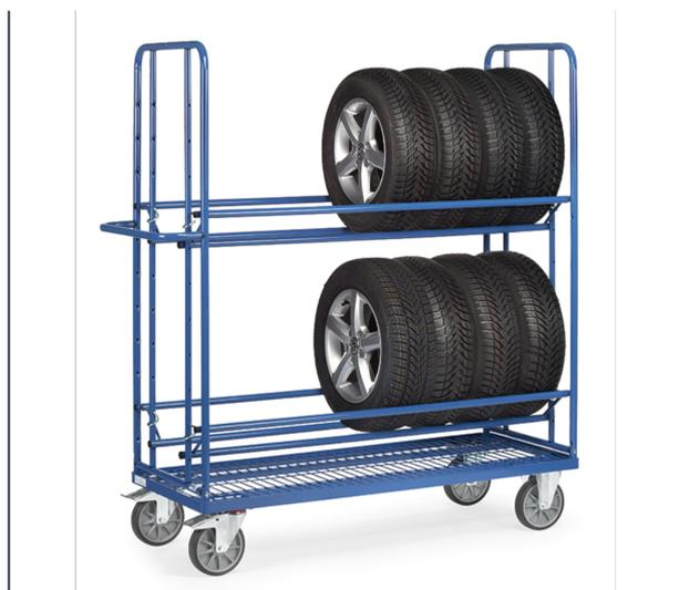
Construction en tube d'acier, revêtement époxy bleu RAL 5007. Plateau avec treillis métallique soudé 140 x 40 mm. Supports réglables au pas de 120 mm. L'articulation des supports permet une adaptation automatique au diamètre des pneumatiques. 2 roues fixes et 2 roues pivotantes à bandage TPE, moyeu à roulement à billes. Freins sur roues pivotantes
