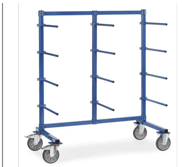
Ensemble mécano-soudé, revêtement époxy bleu RAL 5007. Système modulable pour éléments longs et stockage. Chariot complètement boulonné, barres réglables en hauteur. 1 face avec 12 barres de portée habillées d'un tube de PVC de 3 mm d'épaisseur. Longueur utile: 600 mm. 2 roues fixes et 2 roues pivotantes à bandage TPE, moyeu à roulement à billes. Freins sur roues pivotantes. Charge par étage: 80 kg.
