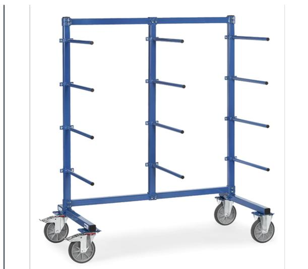
Ensemble mécano-soudé, revêtement époxy bleu RAL 5007. Système modulable pour éléments longs et stockage. Chariot complètement boulonné, barres réglables en hauteur. 1 face avec 12 barres de portée. Longueur utile: 600 mm. 2 roues fixes et 2 roues pivotantes à bandage TPE, moyeu à roulement à billes. Freins sur roues pivotantes. Charge par étage: 80 kg.
