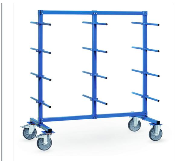
Ensemble mécano-soudé, revêtement époxy bleu RAL 5007. Système modulable pour éléments longs et stockage. Chariot complètement boulonné, barres réglables en hauteur. 2 faces avec 24 barres de portée (12 de chaque côté) habillées d'un tube de PVC de 3 mm d'épaisseur. Longueur utile: 600 mm. 2 roues fixes et 2 roues pivotantes à bandage TPE, moyeu à roulement à billes. Freins sur roues pivotantes. Charge par étage: 120 kg (60 kg de chaque côté).
