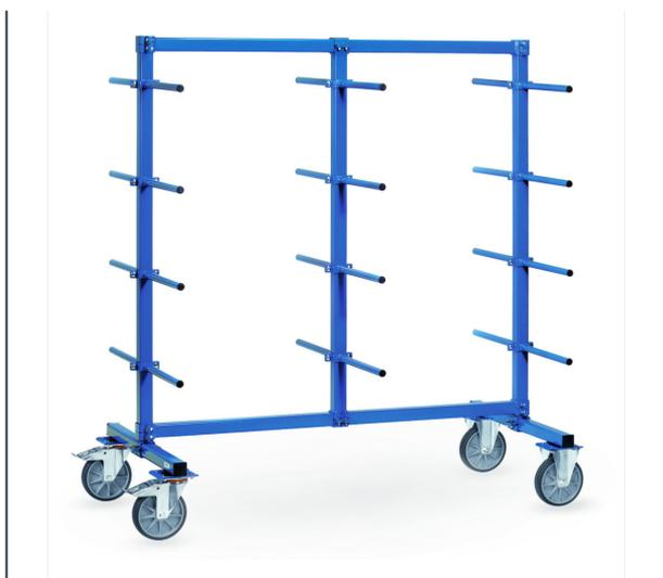
Ensemble mécano-soudé, revêtement époxy bleu RAL 5007. Système modulable pour éléments longs et stockage. Chariot complètement boulonné, barres réglables en hauteur. 2 faces avec 24 barres de portée (12 de chaque côté). Longueur utile: 370 mm. 2 roues fixes et 2 roues pivotantes à bandage TPE, moyeu à roulement à billes. Freins sur roues pivotantes. Charge par étage: 120 kg (60 kg de chaque côté).
