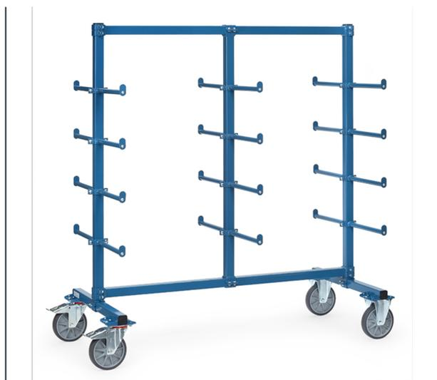
Ensemble mécano-soudé, revêtement époxy bleu RAL 5007. Système modulable pour éléments longs et stockage. Chariot complètement boulonné, barres réglables en hauteur. 2 faces avec 24 barres de portée (12 de chaque côté) avec butée de sécurité. Longueur utile: 600 mm. 2 roues fixes et 2 roues pivotantes à bandage TPE, moyeu à roulement à billes. Freins sur roues pivotantes. Charge par étage: 120 kg (60 kg de chaque côté).
