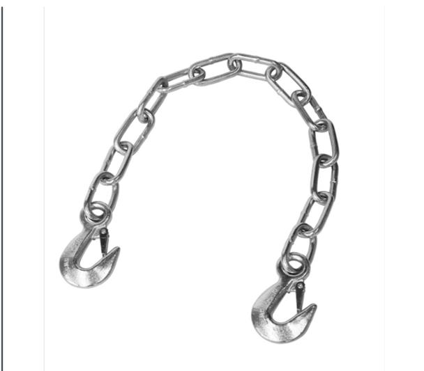
Chaîne de sécurité avec mousquetons. La chaîne se compose de 13 maillons et est équipée de mousquetons des deux côtés. La taille du maillon est de 8 x 52 mm Testé selon DIN 763, charge de rupture 25 KN.
