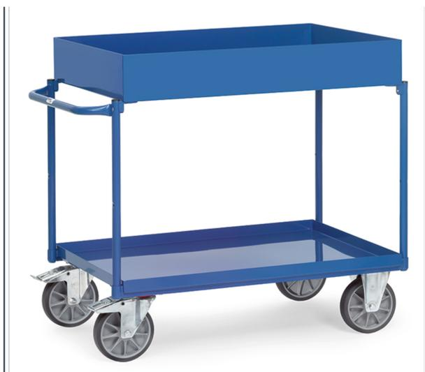
Construction en acier avec 2 plateaux étanches et rebord haut de 150 mm, revêtement époxy bleu RAL 5007, dossier de poussée horizontal. Charge maximum plateau du haut: 200 kg. 2 roues pivotantes et 2 fixes à bandage TPE, moyeu à roulement à billes central. Freins sur roues pivotantes.
