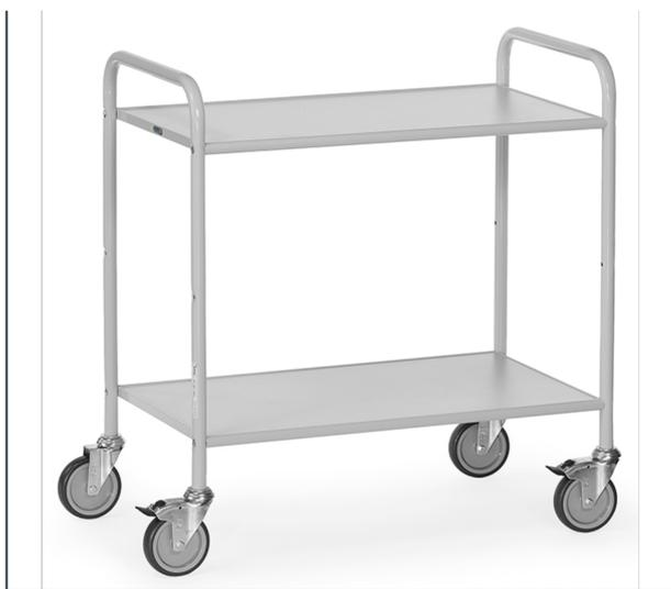
Système modulaire: construction en tube d'acier vissé, revêtement époxy gris clair RAL 7035. 2 plateaux en panneaux dérivés du bois, gris clair. 4 roues pivotantes, roues à bandage TPE, élastiques et faciles à déplacer, non traçant. Moyeu avec palier lisse. 2 roues avec freins. Livraison démontée, montage facile par l'utilisateur.
