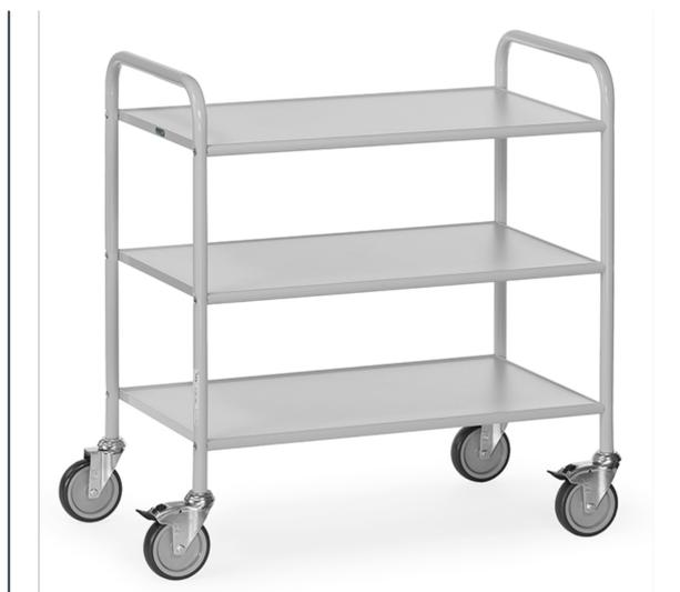
Système modulaire: construction en tube d'acier vissé, revêtement époxy gris clair RAL 7035. 3 plateaux en panneaux dérivés du bois, gris clair. 4 roues pivotantes, roues à bandage TPE, élastiques et faciles à déplacer, non traçant. Moyeu avec palier lisse. 2 roues avec freins. Livraison démontée, montage facile par l'utilisateur.
