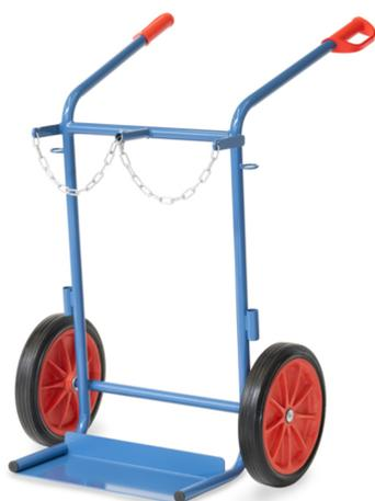
Tube d'acier soudé, revêtement époxy bleu RAL 5007. Diabie porte-bouteilles avec chaîne de maintien. Pour 2 bouteilles de 40 à 50 litres, Ø 204-229 mm. Carquois porte-baguettes de soudage de chaque côté. Roues à bandage caoutchouc, moyeu à roulement à rouleaux.
