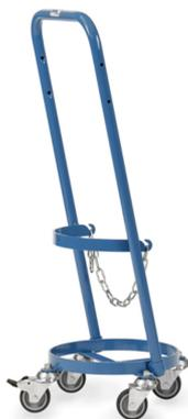
Construction en tube d'acier soudé, revêtement époxy bleu RAL 5007. Rouleur de bouteilles avec chaîne de maintien. Pour 1 bouteille de propane de 11 kg, Ø 300 mm. 4 roues pivotantes à bandage caoutchouc 75 x 25 mm, moyeu à roulement à rouleaux. 2 roues avec freins.
